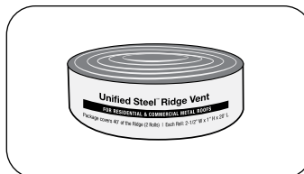
Unified Steel® Ventilación de la cumbre Ventilación de la cumbre continua 17 pulg cuadradas (NFVA)/pies de largo 2.5 pulg x 1 pulg x 20 pies (64 x 25 x 6096 mm)
